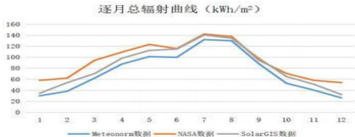
图2.2-4Meteonorm和NASA、SolarGIS逐月总辐射曲线 (kWh/m 2 )
